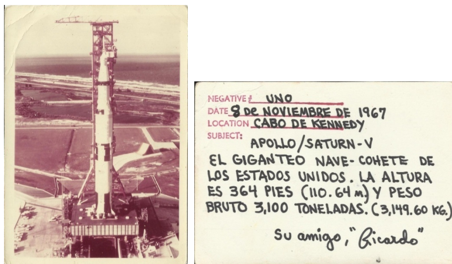
“Apollo/Saturn-V. A gigante nave-foguete dos Estados Unidos. A altura é de 364 pés (110.64 m) e o peso bruto de 3,100 toneladas (3,149.60 kg)”
