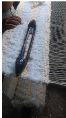
Figura 4: lançadeira. O tecelão a utiliza para fazer a trama.
