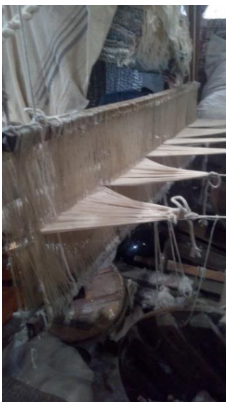
Figura 3: Parte em que se amarra os fios do rolo no linço do tear.
