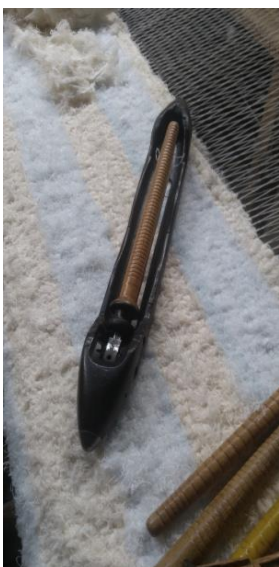
Figura 5: Lançadeira com a espula. O fio que se usa na espula no momento de tecer é utilizado para fazer a trama.
