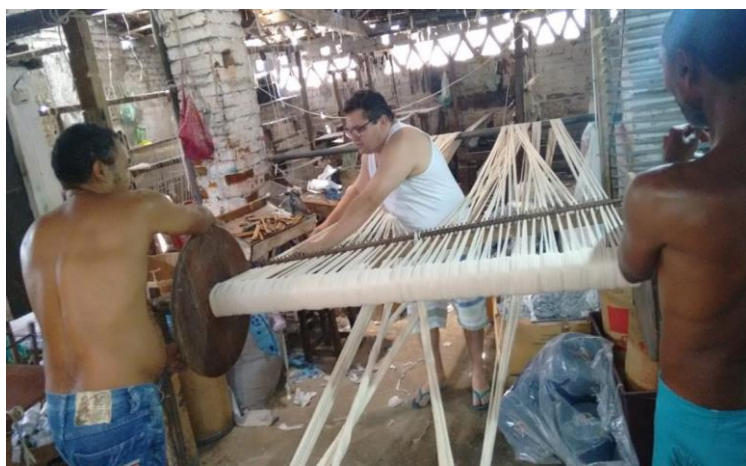
Figura 2: Transferência dos fios da urdideira para o rolo do tear.
