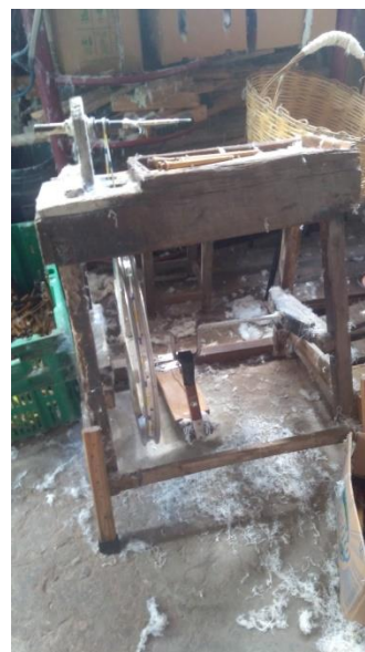
Figura 6: Caneira. Dispositivo no qual se abastece a espula com fios.
