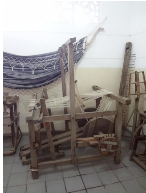
Figura 8: Tear, peça onde se confecciona o pano da rede. Fonte: Museus Funjáder.
